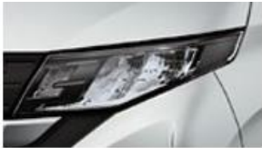
●フルLEDヘッドランプ（クリアランスランプ、オートライト、マニュアルレベリング機能付）
